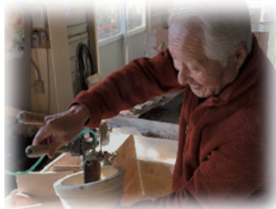
薄い皿などは鋳型を利用することが多く、 深い器は、専用の型を作成した電動ろくろで成型する
