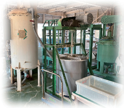
土こねは機械を利用するが、 人の目視による粘度の確認は不可欠
